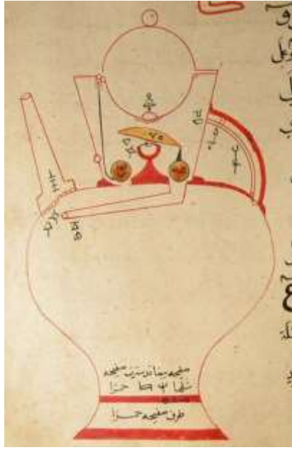
Şekil 4. Cezeri'nin iki farklı sıvı içeren düzeneği ( el-Cami Beyne'l-İlmi ve'l-'Amel e'n-Nafi' fi Sina'ati'l Hiyel 165r, Ayasofya 3606)
