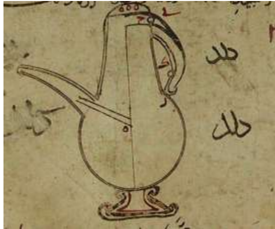
Şekil 1. Philon'un iki farklı sıvı içeren düzeneği ( Kitâbu Fîlyûn fî'l-Hiyeli'r-Rûhâniyye ve Mihânîki'l-Mâ' 26r, Ayasofya 3713)
